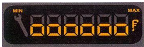
Engine Oil Level Indicator نشانگر سطح روغن موتور
