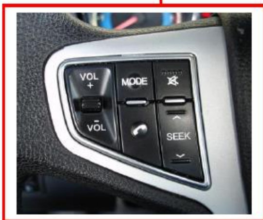
کلیدهای تعبیه شده کنترل و رادیو پخش روی غریبک فرمان
