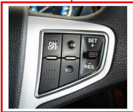
کلیدهای تعبیه شده کنترل و رادیو پخش روی غریبک فرمان
