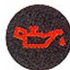
Engine Oil Pressure Warning Symbol علامت هشدار فشار روغن موتور
