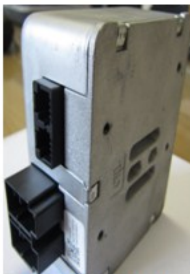
واحد کنترل الکتریکی فرمان
